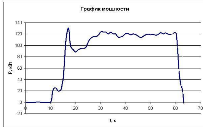
Рис. ПЕ.3. Экспериментальная кривая потребляемой мощности двигателя МЧХ-250.
