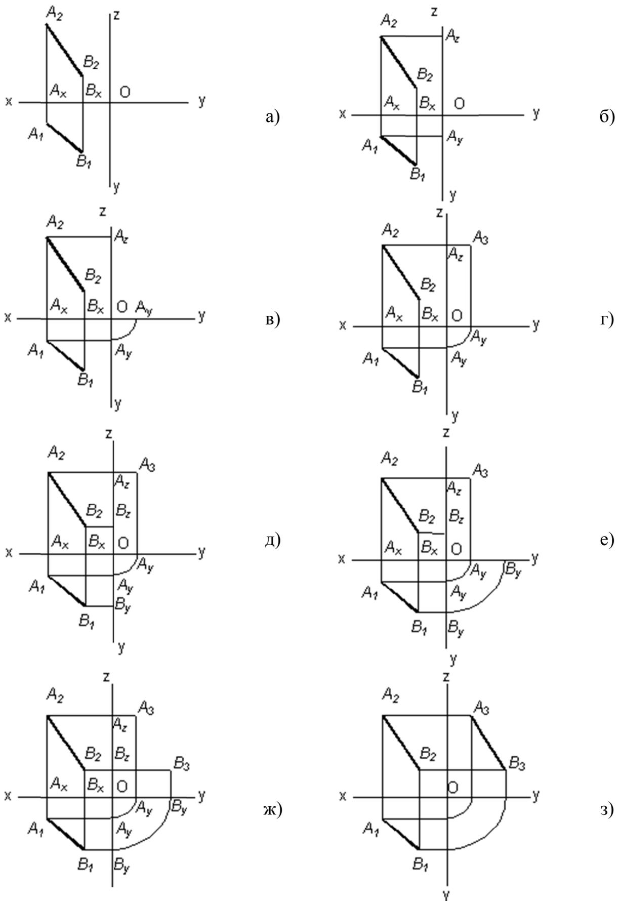
**Рис. 4.** Построение третьей проекции прямой
