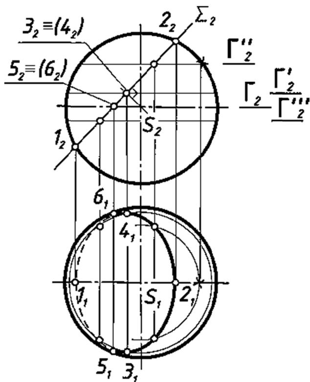
**Рис. 12.** Построение линии пересечения сферы плоскостью
