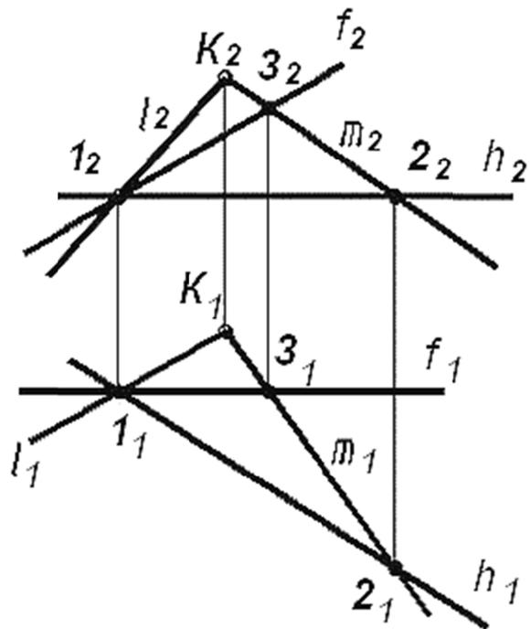
Рис. 7. Частные линии плоскости
