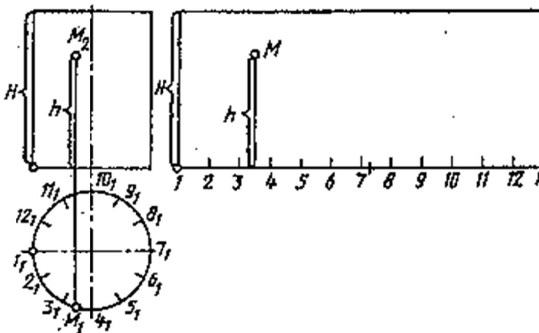
Рис. 20. Развертка цилиндра
