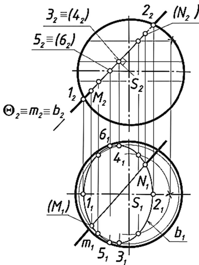
**Рис. 15.** Определение точек пересечения сферы прямой
