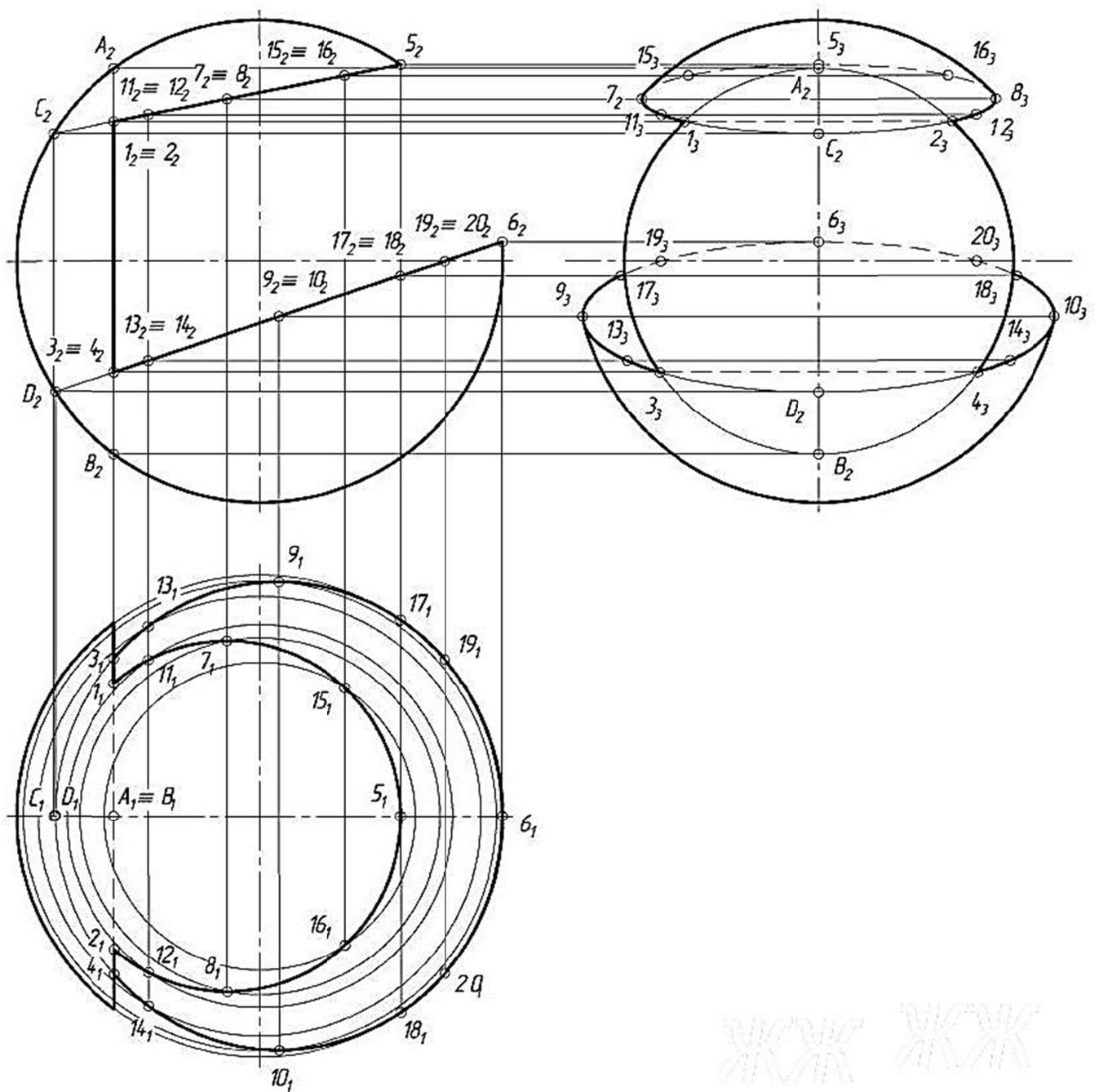
Рис. 22. Сфера со сквозным вырезом
