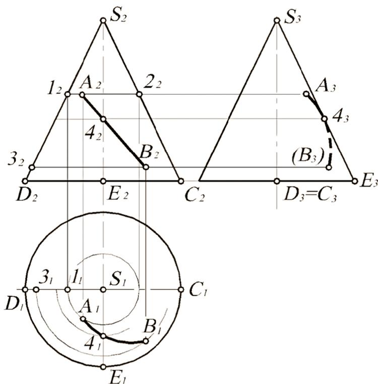
**Рис. 14.** Построение проекций точек и линии на поверхности конуса
