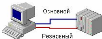
Рис. 36. Резервирование связи с контроллером.
