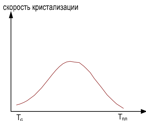
Рис.9. Зависимость скорости кристаллизации от температуры полимера
