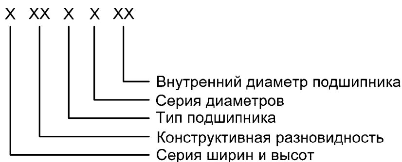
Рис.3.1. Схема условного обозначения подшипника
