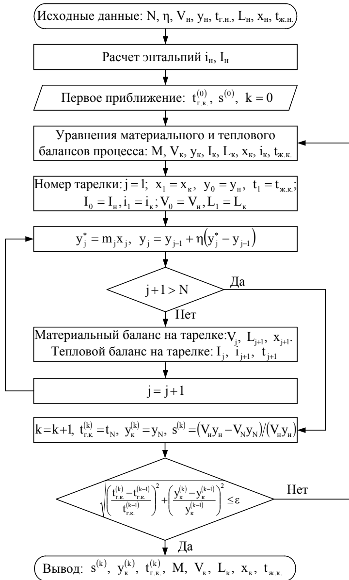
Рис. 2.2. Алгоритм расчета абсорбера со ступенчатым контактом фаз
