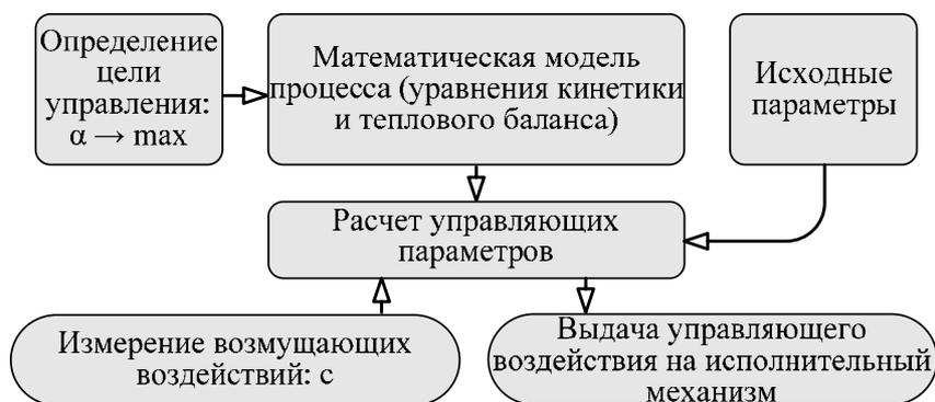
Рис. 4.5. Структура системы управления реакционной установкой
