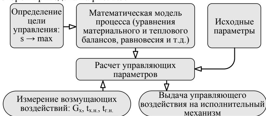
Рис. 2.3. Структура системы управления абсорбционной установкой
