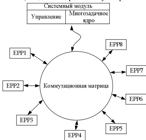
**Рис. 34** Структура коммутатора EtherSwitch компании Kalpana
