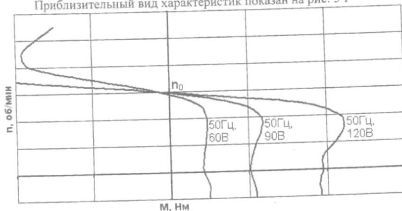
Рис. 5. Механические характеристики при различных напряжения статора АД
