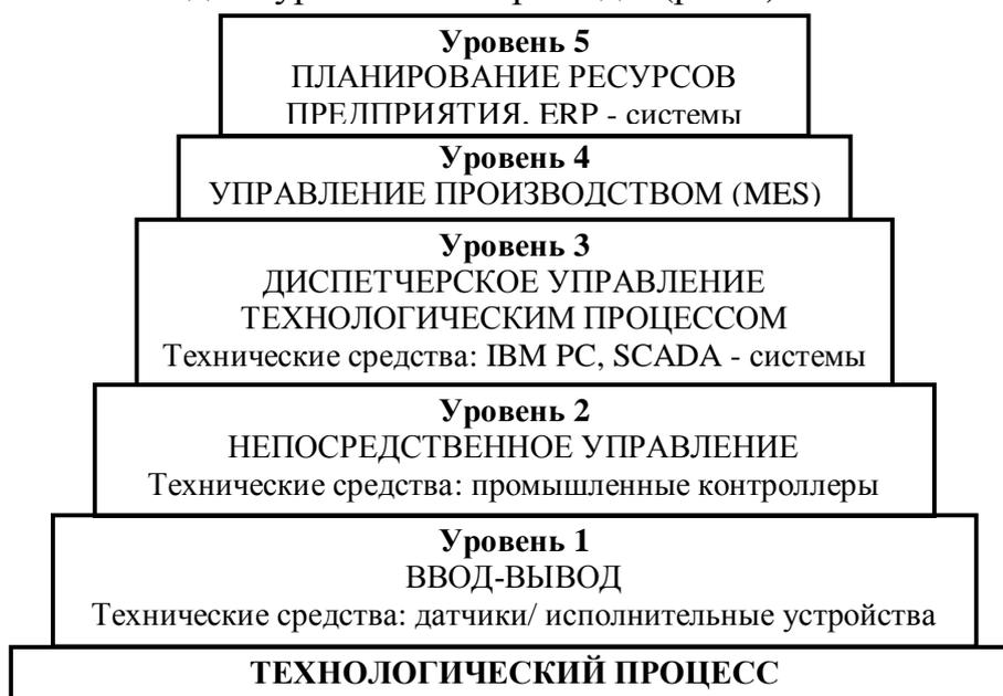
Рис.1. Уровни интегрированной системы автоматизации производства
