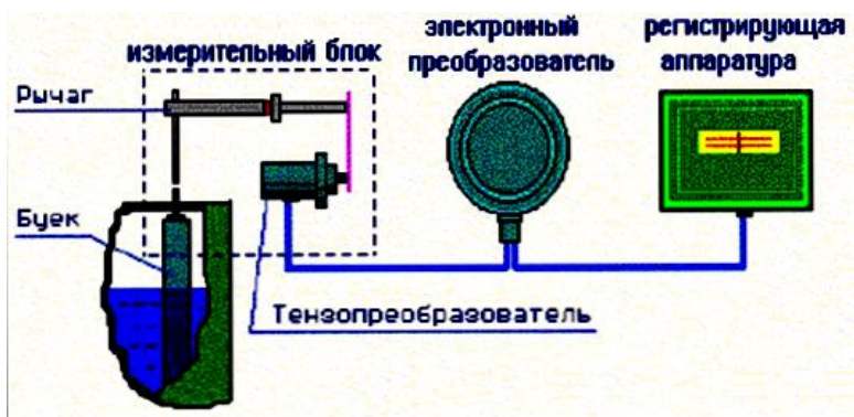
Рис. 3. Схема измерительного преобразователя уровня буйкового САПФИР-22ДУ-Вн(Ех)
