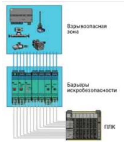
Рисунок 4 - Подключение оборудования взрывоопасной зоны через барьеры искробезопасности
