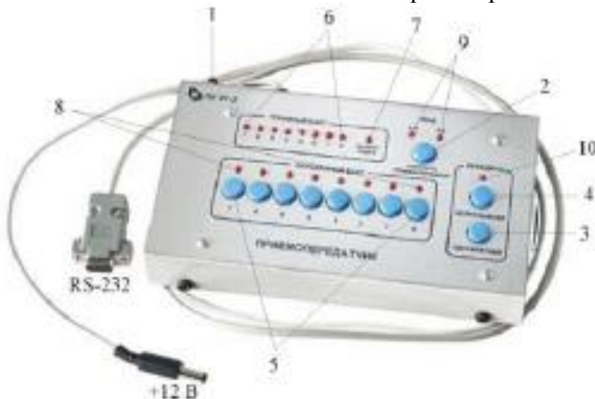
Рис. 2. Приемопередатчик по RS-232
