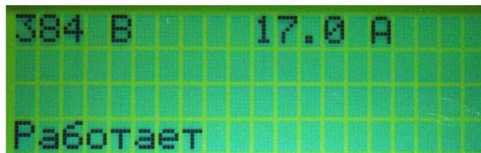
**Рис. 2.11.** Показания ЖКИ дисплея при работе УПП
