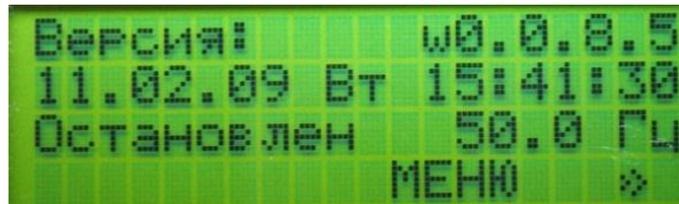
**Рис. 2.10.** Показания ЖКИ дисплея при включении УПП
