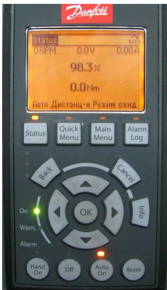
Рис. 3.6. Общий вид панели графического LCP
