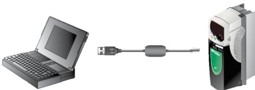
**Рис.7.11.** Пример подключения UnidriveSP к ПК с помощью соединительного кабеля – преобразователя интерфейса USB в RS-485
