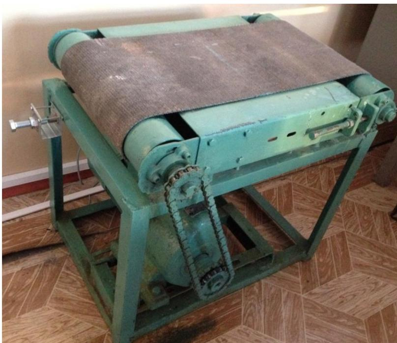
**Рис.5.5.** Ленточный транспортер
