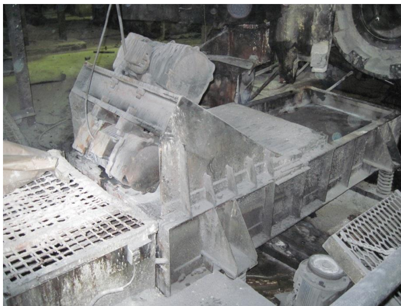
Рис. 5.1. Вибрационный влагоотделяющий транспортирующий конвейер
