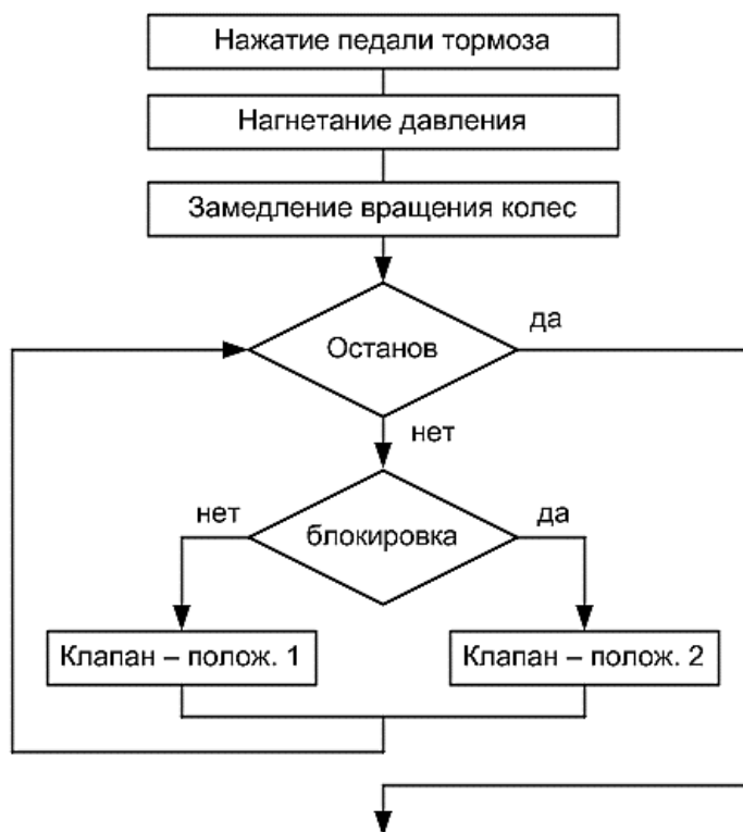
Рис. 2. Схема работы тормозной системы с АБС
