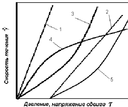
Рисунок 4.1 – Различные типы кривых течения: 1 - ньютоновская жидкость; 2 - идеальное пластичное тело; 3 - псевдопластичная жидкость; 4 - дилатантная система; 5 - реальное пластичное тело.
