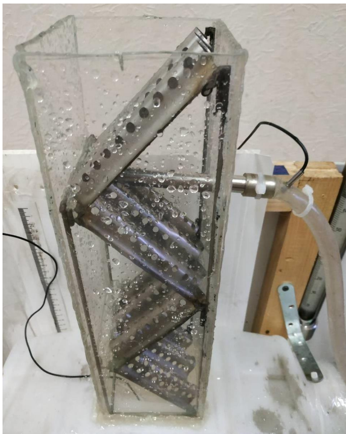
Рис. 2.3. Фотография блока с наклонно-гофрированными контактными элементами
