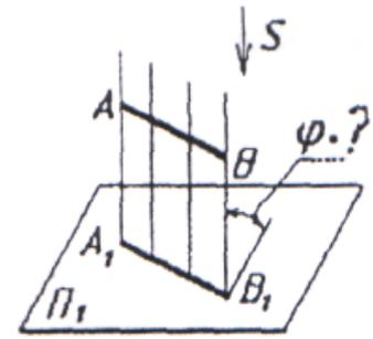
4. На каком чертеже построена ортогональная проекция отрезка АВ: \_\_.
