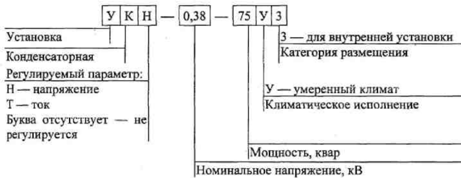
Рис. 3.1. Структурная схема условного обозначения компенсирующего устройства Пример 3.1.
