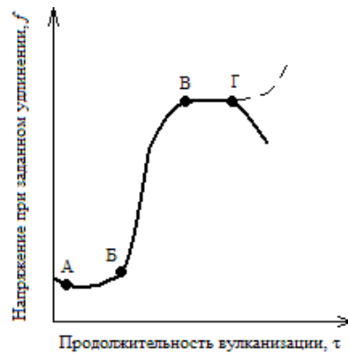
Рисунок 2 – Зависимость напряжения при заданном удлинении от продолжительности вулканизации
