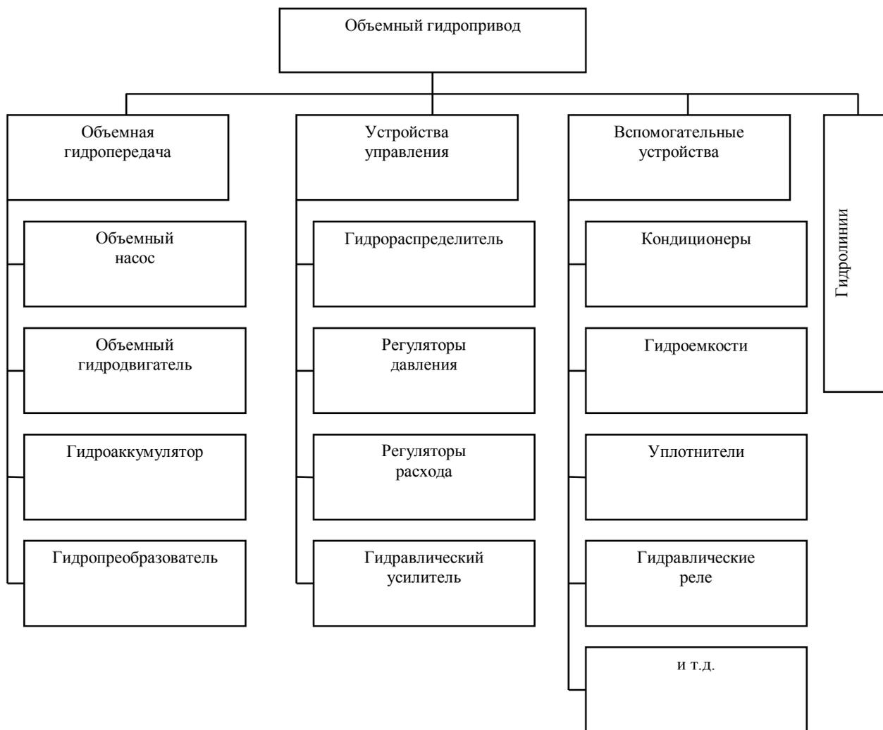
Рис. 2. 1. Схема объемного гидропривода
