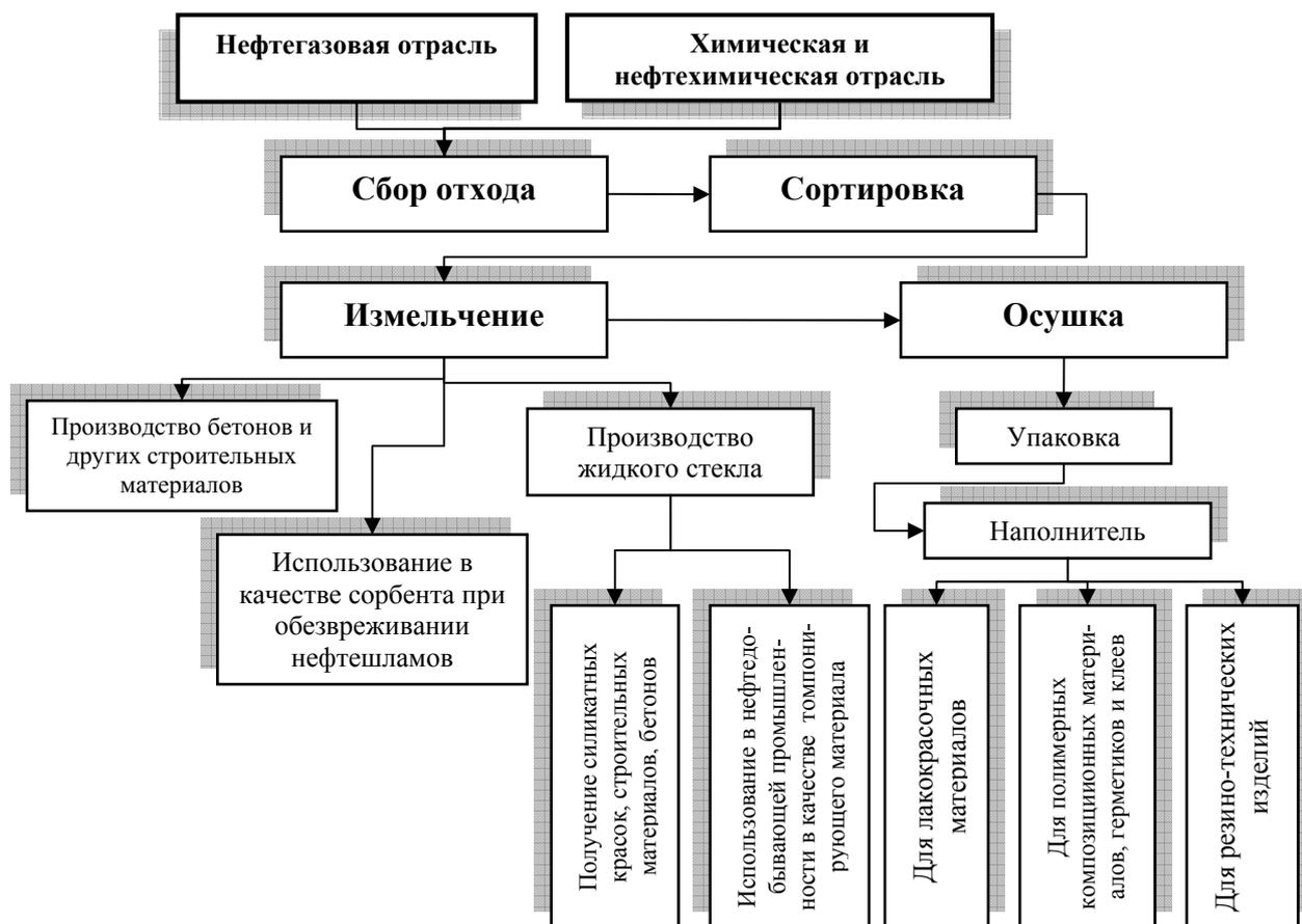
Рис. 1. Схема комплексной утилизации отработанного силикагеля
