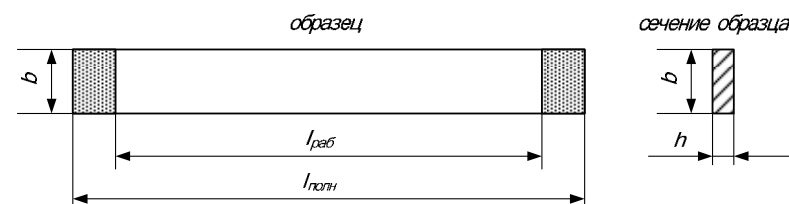
Рис. 1.1. Плоский образец для испытания на растяжение
