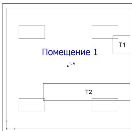
Рис. 2. План размещения светильников (теоретический метод расчета)
