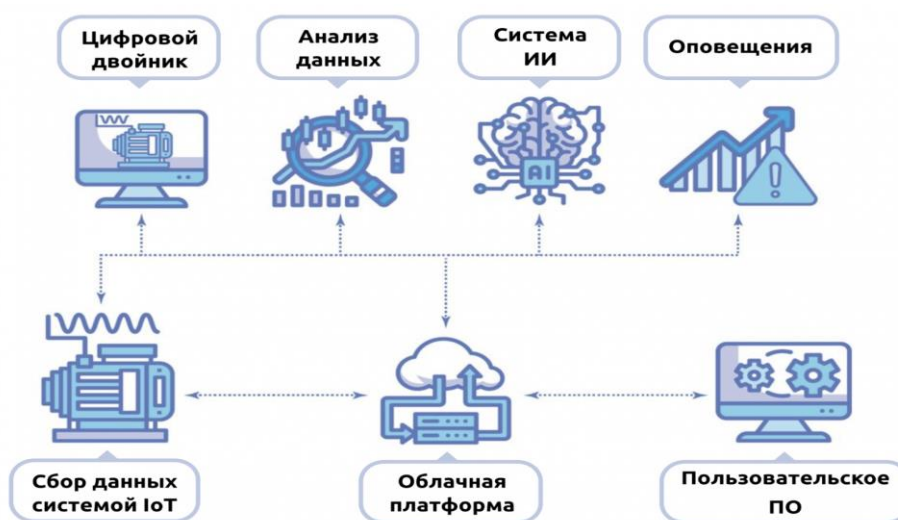
Рис. 2 Схема системы диагностики состояния оборудования
