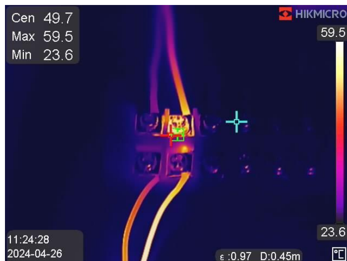
Рис. 8. Термограмма плохого контакта после минутного протекания тока
