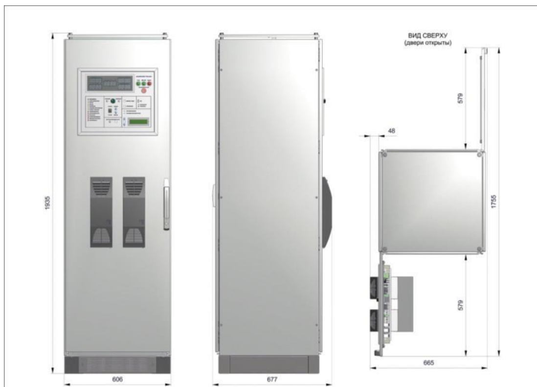
Рисунок 1.1 - Цифровой регулятор возбуждения синхронного двигателя АНИКРОН ТМ-03. Внешний вид.
