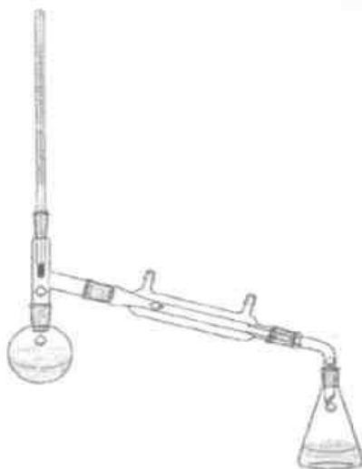
Р и с. 2.1. Простая перегонка
