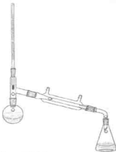
Р и с. 2.1. Простая перегонка
